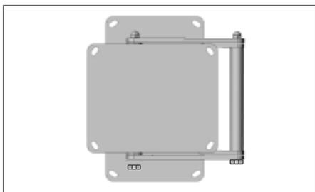
01 - Ajuste o cj. articulador (4) na parede de acordo com sua preferência. Observe que quando o suporte se encontra com a articulação fechada, as chapas ficam centralizadas.
