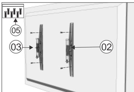
05 - Com o Plasma na vertical, fixar os Cj. Basculante direito e esquerdo (02 e 03) utilizando o kit básico de parafusos (05), posicionando-os de forma mais centralizada possível.
