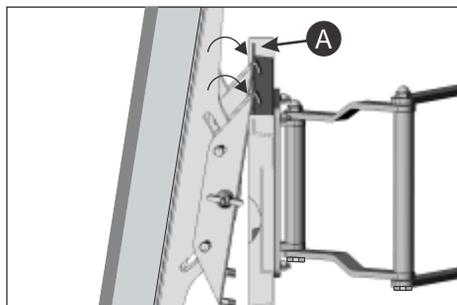
07 - Coloque a TV Plasma na chapa do suporte(1), incline levemente a TV e encaixe na aba superior (A) da chapa do suporte plasma.
