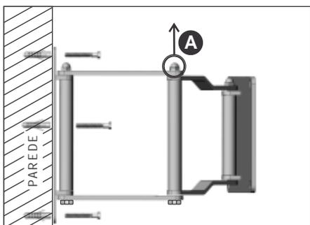
03 - Fixe as Buchas na parede, parafuse os seis pontos do suporte. Certifique-se que os parafusos dos articuladores estejam para cima (A).
