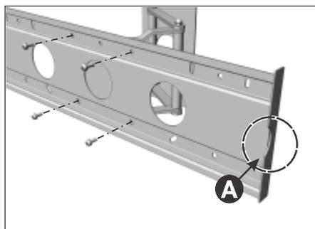
04 - Parafuse a chapa do suporte plasma (01) na chapa do conjunto articulador, nos quatro pontos indicados utilizando os parafusos Allen (6). Certifique-se que o corte na lateral da chapa (A) esteja voltada para frente.
