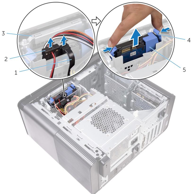
**Figura 7. Como remover o conjunto do disco rígido**
