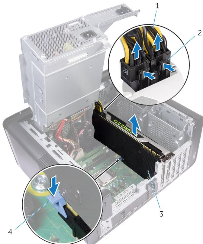
**Figura 22. Como remover o cabo de alimentação**
