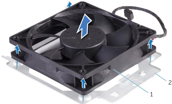
**Figura 19. Como remover o ventilador do chassi**
