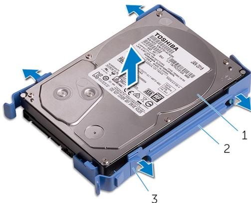
**Figura 8. Como remover o disco rígido do suporte**
