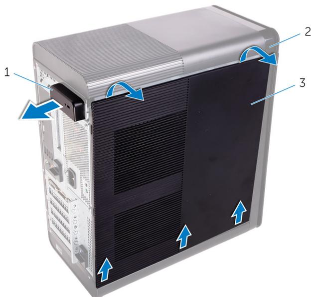
**Figura 1. Como remover a tampa lateral direita**
