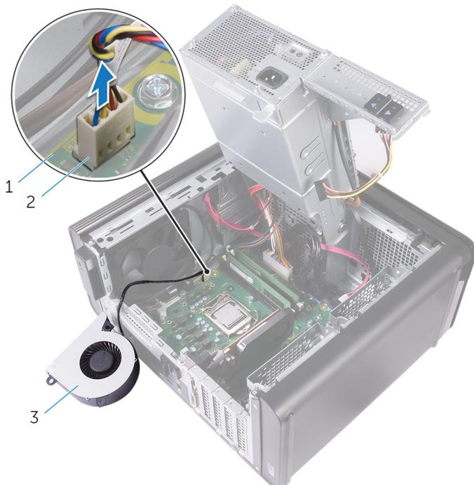
**Figura 33. Como remover o cabo do ventilador**
