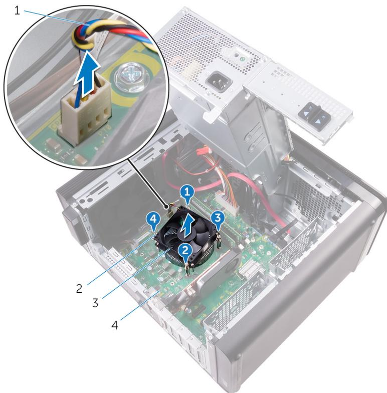
**Figura 34. Como remover o ventilador e dissipador de calor do processador**
