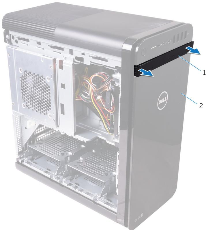
**Figura 5. Como remover o bezel da unidade óptica**
