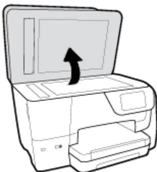
2. Coloque o original com o lado impresso para baixo, conforme mostra a ilustração.
